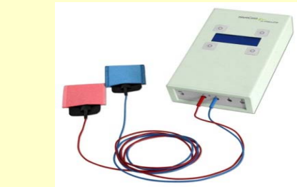
← tDCS装置と電極配置 DC Stimulator plus (NeuroConn社)
